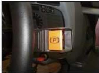
EPB действует прямо на основные задние тормоза в комбинации с электронным контроллером и механическим блокирующим механизмом.
