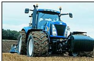
Подходит только для тяжелых полевых работ благодаря конструкционным особенностям, и то с сильно загруженным передним мостом (балласт должен быть приблизительно около 2 тонн). Распределение веса между мостами 35% перед и 65% зад.
