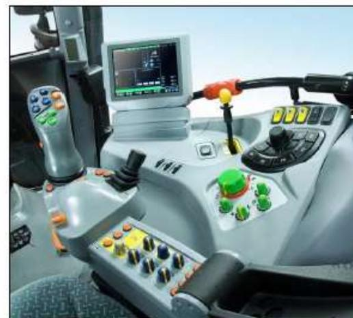
Все модели оснащены много-функциональным рычагом "PowerComS" расположенным на подлокотнике и гарантирующим управление всеми основными функциями с помощью пальцев «fingertips control».
