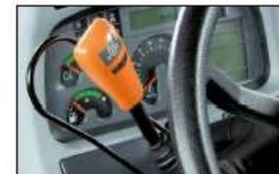
Пример: При операциях когда оператору приходится часто изменять направление движения, колесо модуляции следует установить в быстрое положение.
