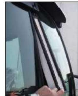
Тракторы серии AGROTRON L оснащены одной из самых лучших систем на рынке. Два фильтра расположены с обеих сторон кабины. Быстрый и легкий доступ для замены. Возможность установки угольных фильтров.
