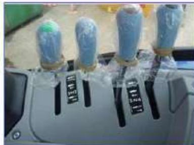
Полевые испытания продемонстрировали, что рычаги управления гидравликой на NH T7050 расположены слишком близко друг к другу. Довольно сложно управлять без того, чтобы не задеть соседний рычаг.
